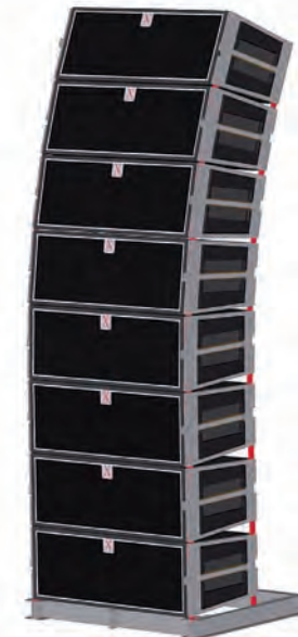
El sistema de apilado está dimensionado para un máximo de 8 unidades XTLSA más 4 unidades XTLSAS .
